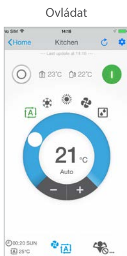
Řízení provozního režimu, teploty, čištění vzduchu, otáček ventilátoru a směru proudění
